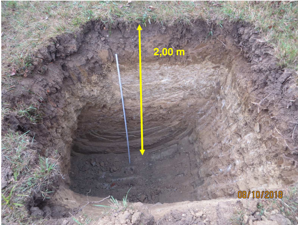
Abbildung 3: Blick in den Baggerschurf vor Einfüllung des Wassers.
