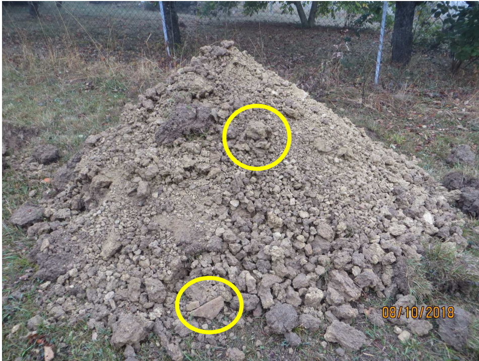
Abbildung 1: Aushubmaterial –schluffiger, bindiger Boden mit Kalksteingeröll.
